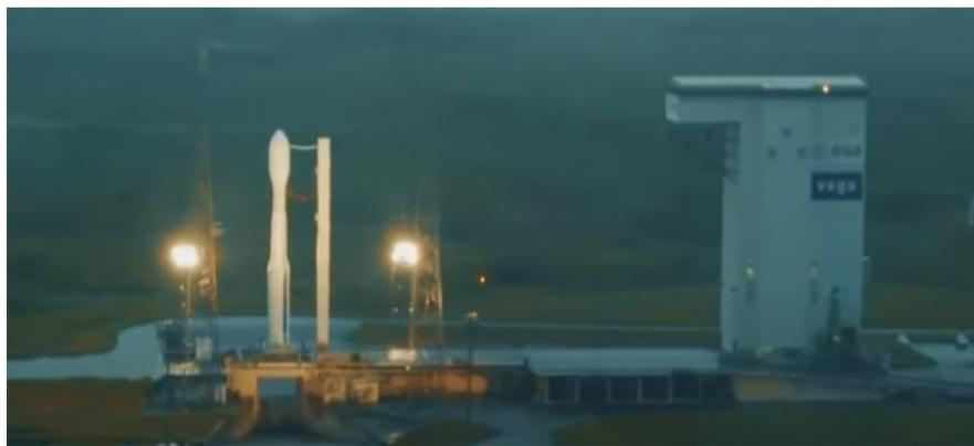
Si compone da tre stadi a propellente solido, sormontati da uno stadio superiore alimentato da un motore-razzo che brucia gas liquido. Può dispiegare più satelliti posizionandoli su orbite diverse. Il lanciatore è progettato per un'affidabilità del 98%. L'accuratezza dell'orbita ottenuta è di 15 km. La versione iniziale ha una
